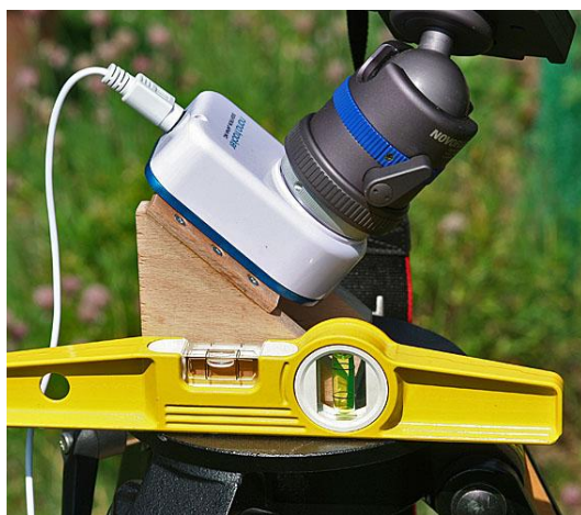
Bild 5 Ausrichten des Stativs mit Hilfe einer Wasserwaage
