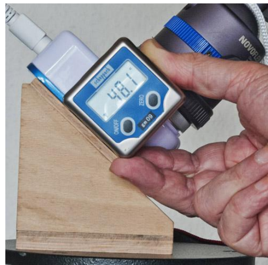
Bild 4 Kontrolle der Polhöhe mit einer digitalen Neigungswasserwaage
