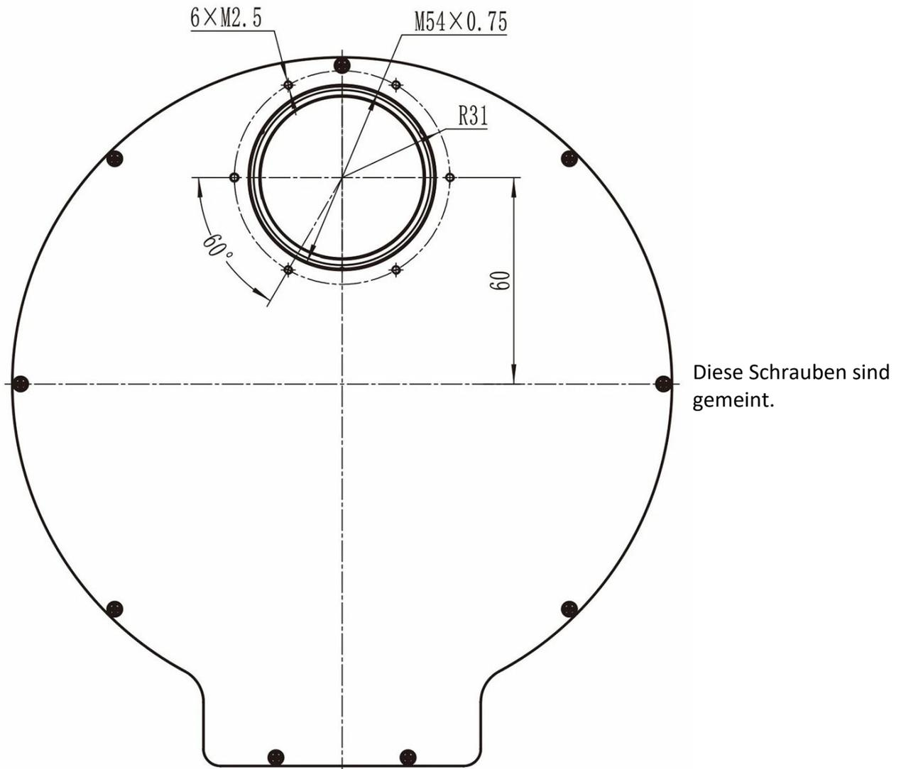
Nun kann die Abdeckplatte abgenommen werden und die Filter sind zugänglich. Die Kamera kann montiert bleiben.
