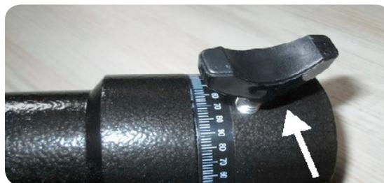
Öffnen Sie nun zuerst die Klemmschraube an der oberen Achse (Dec-Achse).
