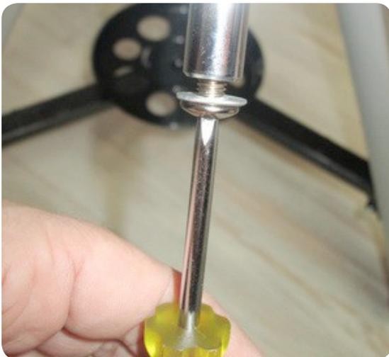
Drehen Sie mit dem Schraubendreher die Sicherungsschraube am Ende der Gegengewichtsstange heraus.
