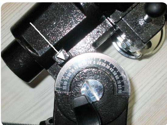
Unterstützen Sie dabei mit der anderen Hand die Montierung/das Teleskop, um die Einstellschraube zu entlasten.
