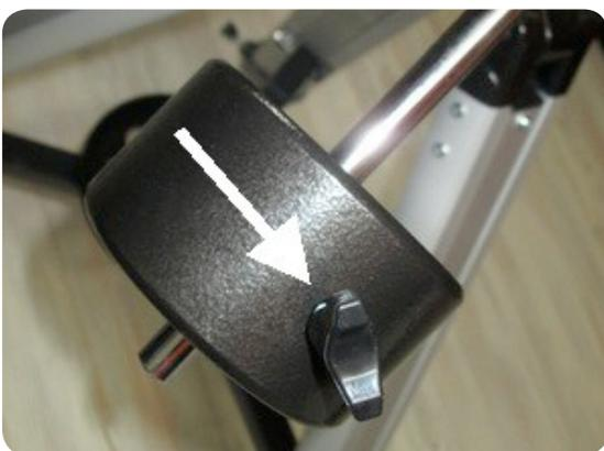
Lösen Sie nun die Feststellschraube des Gegengewichtes, schieben Sie das Gewicht auf die Stange und arretieren Sie es mit der Feststellschraube.
