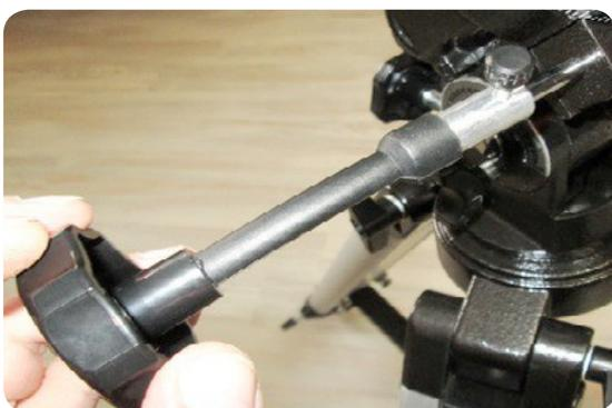
Lösen Sie die Klemmschraube der Welle und schieben Sie die Welle so auf die Achse, dass die Klemmschraube auf der abgeflachten Seite der Achse sitzt.
