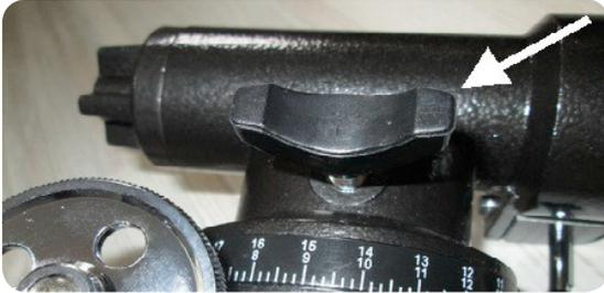
Vergewissern Sie sich, daß die Dec-Achse arretiert ist und öffnen Sie die Klemmschraube der RA-Achse.
