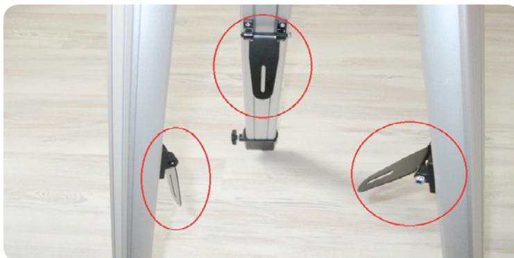
Anschließend befestigen Sie die Stativbeine mittels der drei Schrauben ,M' am Montierungskopf. Diese Schrauben sollten Sie noch nicht allzu fest anziehen.
