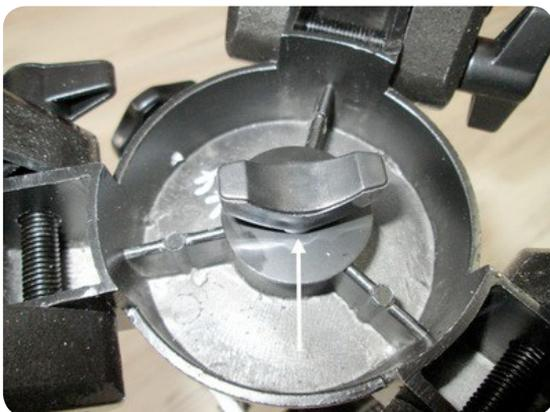
Spreizen Sie zunächst die Beine des Stativs für einen sicheren Stand. Setzen Sie dann den Montierungskopf auf und befestigen Sie diesen von unten mit der Schraube „F“.
