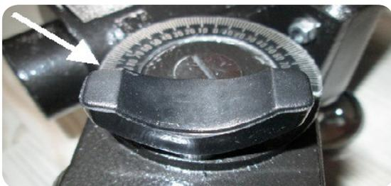
Lösen Sie die Klemmschraube am Polblock der Montierung.
