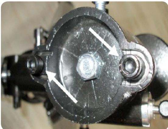
Entfernen Sie mit dem beiliegenden Innen-sechskantschlüssel die für das Befestigen der Rohrschelle(n) vorgesehenen Schrauben.
