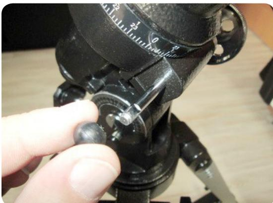
Befestigen Sie als nächstes die beiden biegsamen Wellen an der Montierung. Die kurze Welle ‚I‘ befestigen Sie an der unteren Achse (Rektaszensionsachse/RA-Achse). Entfernen Sie dazu die Gummischutzkappe vom der Wellenachse der Montierung.
