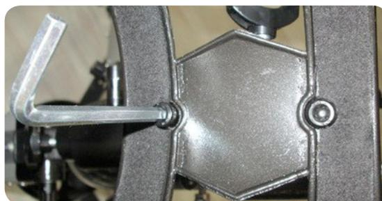
Befestigen Sie die Rohrschelle(n) mit den vorgenannten Schrauben.
