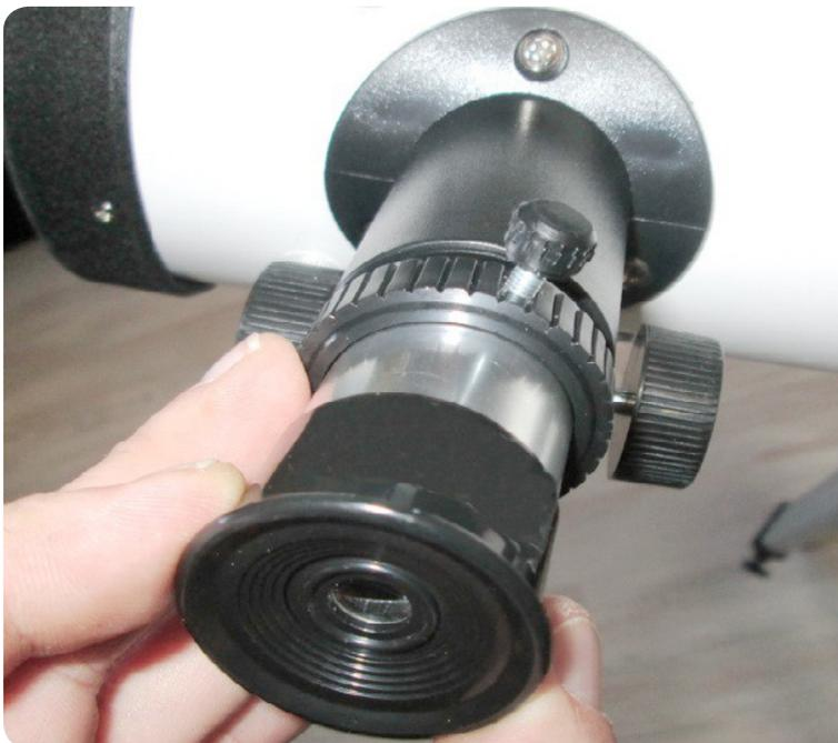
Nun müssen Sie noch den Sucher zum Teleskop ausrichten (justieren). Dazu stecken Sie zunächst das Okular mit der größten Brennweite in den Okularauszug.
