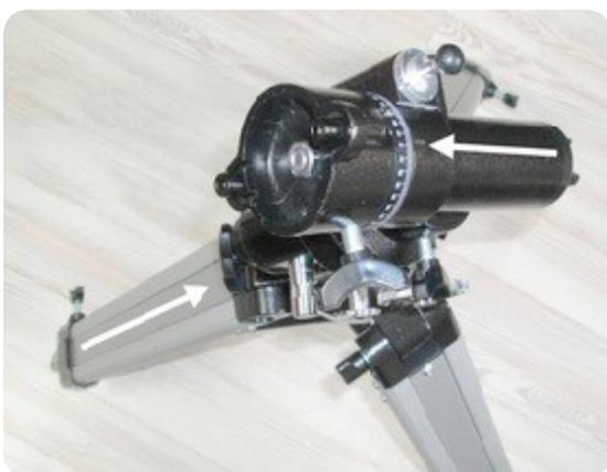
Befestigen Sie den Montierungskopf so, dass die obere Achse (Deklinationssachse) in einer Linie zu einem Stativbein verläuft. Das erleichtert Ihnen die Einnordung.
