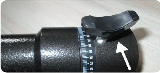
Lösen Sie ggf. die Klemmschrauben der Montierungsachsen, drehen Sie die Achsen so, daß die beiden Schrauben bzw. Schrauben-
