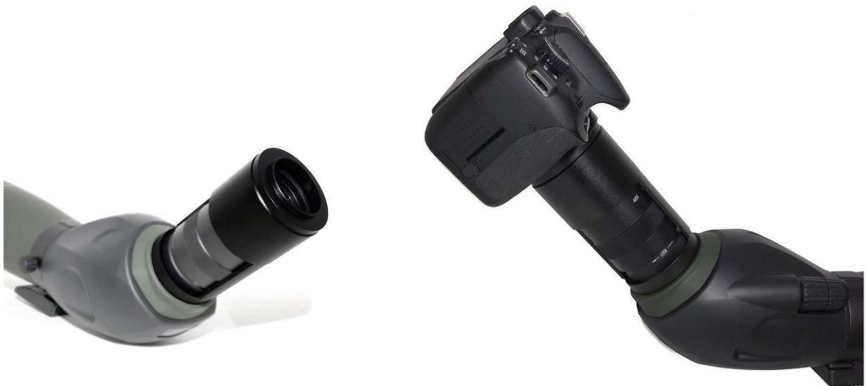
Der notwendige T2 Kamerabajonettadapter wird auf den Fotoadapter geschraubt und die Kamera über den Bajonettanschluss aufgesetzt.
