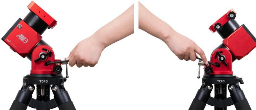
Ziehen Sie die AM3-Schwalbenschwanz-Sattelplatte hoch. Sie werden bemerken, dass die beiden Sechskantschrauben an das andere Ende der Gleitführung gleiten. Wenn der Breitengradwinkel bei etwa 75° liegt, ziehen Sie die Sechskantschrauben auf beiden Seiten wieder fest.
