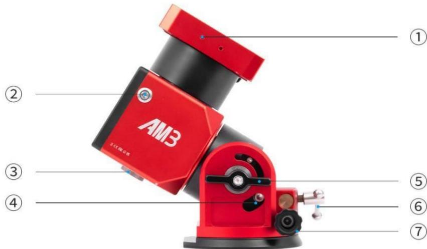
• **Sucherschuh-Montagelöcher:** Können verwendet werden, um die ZWO-Sucherhalterung zu installieren, an dem der ASI AIR montiert werden kann.
