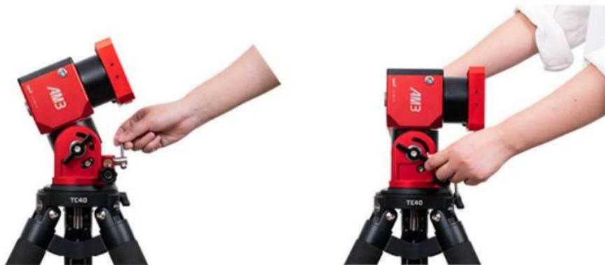
Um den Breitengradwinkel von 90° auf 0° einzustellen, führen Sie die obigen Schritte in umgekehrter Reihenfolge aus.
