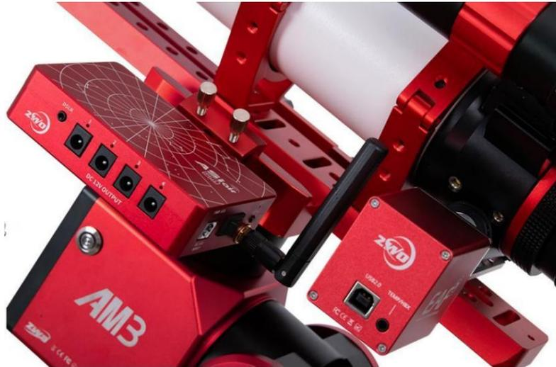
Schritt 3: Schalten Sie ASI AIR und AM3 ein. Wenn das System von ASI AIR bereit ist, wählen Sie das entsprechende ASI AIR-Funksignal im WLAN Ihres Smartphone.
