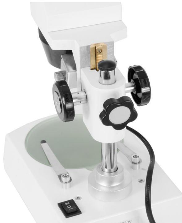
Die Fokussierung erfolgt über eine Zahnstange.
