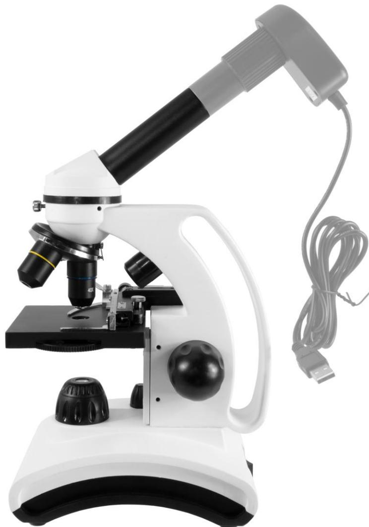
An Stelle des Okulares kann eine Kamera eingesetzt werden. Die Mikroskop Kamera TSMD130 kann ohne weiteres Zubehör in den Okularaufsatz eingesteckt werden. Schauen Sie auf die Live-Ansicht der Kamera. Stellen Sie das Kamerabild über die Mikroskopfokussierung scharf.
