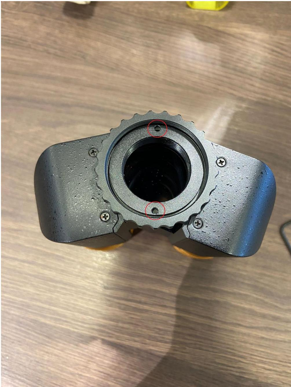
2. Schrauben vom Gehäuse lösen
