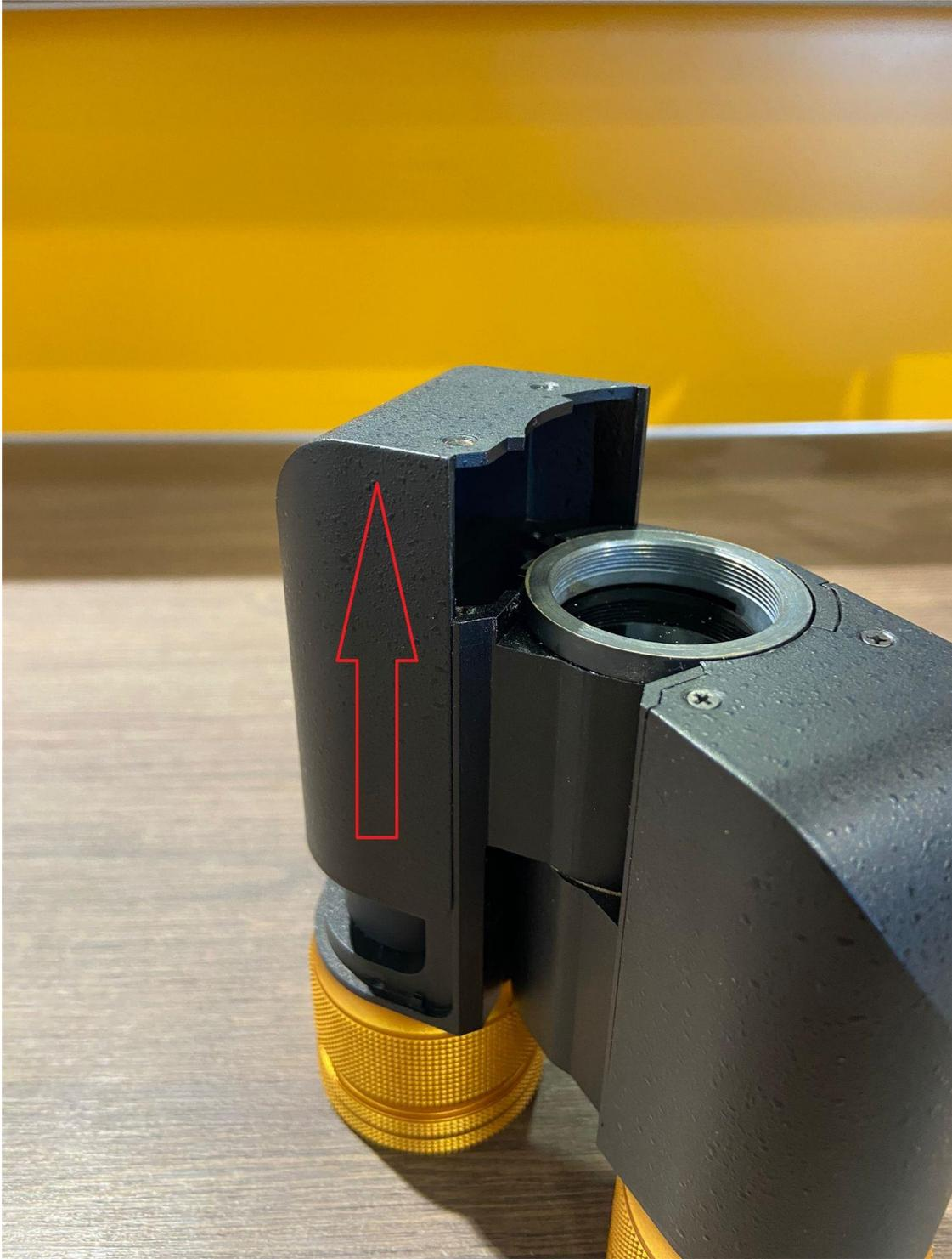
4. Justageschrauben sind nun frei gelegt. Auf der gegenüberliegenden Seite sind ebenfalls zwei Schrauben. Überwurfmutter wieder anschrauben -> An Optik bauen -> Okulare einsetzen -> An Zug- und Pressschrauben justieren, bis es optisch Scharf ist. (Hier muss ausprobiert werden, es gibt keine direkte Regel.
