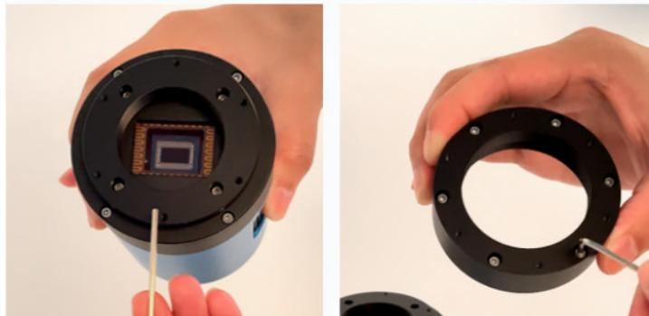
Setzen Sie die 6 langen Schrauben (M2,5x20) in die Bohrungen des Extenders ein und befestigen Sie damit den Extender an der Kamera. Ziehen Sie die Schrauben vorsichtig an.
