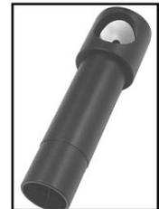
**Zenitspiegel für aufrechtes Bild (#94112-A)** – Bei diesem Zubehör handelt es sich um eine Amici-Prismenanordnung, die Ihnen einen Blick in einem 45°-Winkel in das Teleskop ermöglicht und die Bilder richtig ausrichtet (aufrecht und korrekt von links nach rechts).
