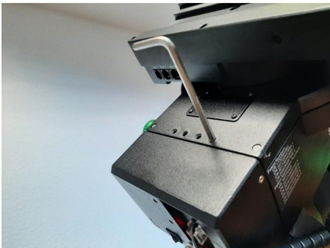
Anschließend **zieht** man die inneren beiden Schrauben um den gleichen Wert vorsichtig an. (Siehe Bild 3)
