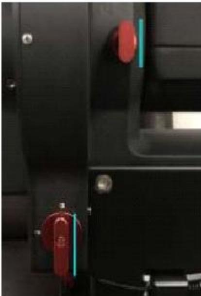
**Stellen Sie den Gangschalter NUR in die Verriegelungsposition, um den Schnecken- / Zahnkranz während des Betriebes der Montierung einzulegen. Verriegeln Sie den Achsensperrknopf IMMER während dem Transport und der Aufstellung der Montierung.**
