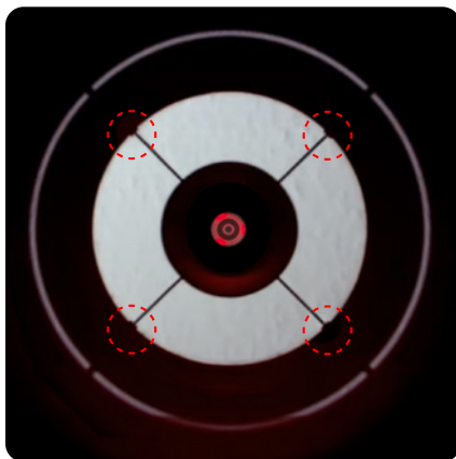
Gut justiertes RC-Teleskop
