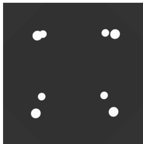
Stark dejustierter Refraktor
