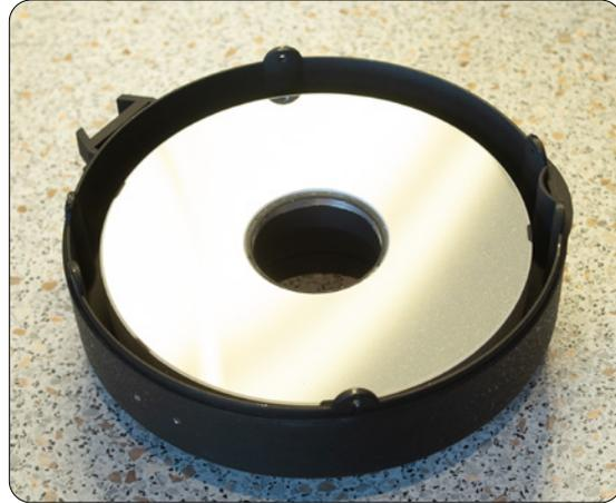
Verbinden Sie Haltering und Blendrohr und schrauben Sie die Baugruppe auf den Träger. Prüfen Sie, sobald ein größerer Widerstand zu spüren ist, ob sich der Spiegel noch bewegen läßt. Dieser muß noch leicht zu drehen sein, darf sich aber keinesfalls kippen lassen.
