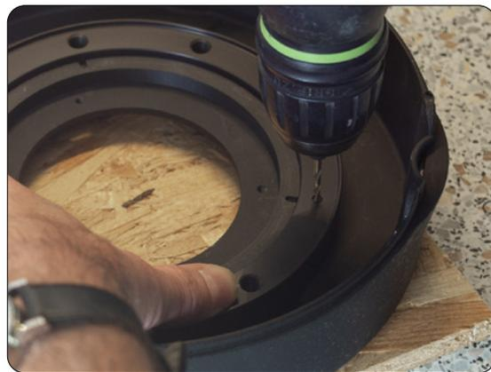
Entfernen Sie den Ring und vergrößern Sie die 3-mm-Bohrung auf 8 mm.
