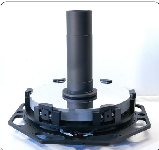
Legen Sie die Rückplatte mit der Zelle auf einer schützenden Unterlage ab und entfernen Sie das Blendrohr. Achten Sie darauf, den Spiegel nicht zu berühren.
