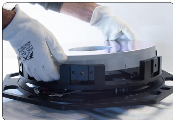
Legen Sie den Spiegel mit der Unterseite nach oben vorsichtig auf den Filzgleitern ab und entfernen Sie mit dem Schaber, einem geeigneten Lösungsmittel (Spiritus, Isopro-
