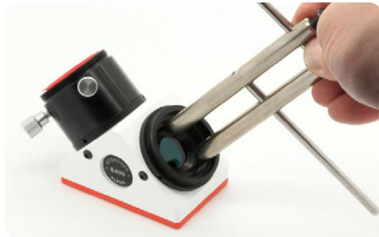
Wenn der Haltering entfernt ist lässt sich das alte Blauglas entnehmen. Entfernen Sie gegebenenfalls Silikonreste und Staub. Setzen Sie anschließend das neue Blauglas ein sichern Sie es vorsichtig mit dem Haltering.
