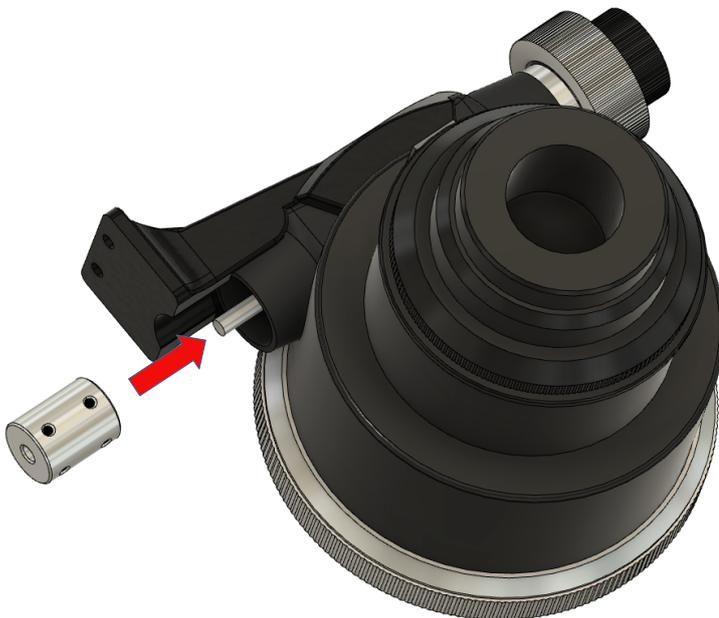
4. Falls diese noch nicht eingeschraubt sind, 4x M3x5mm Gewindestifte in die bewegliche Kupplung leicht eindrehen. Danach wird die bewegliche Kupplung auf die Welle des Okularauszuges gesteckt.
