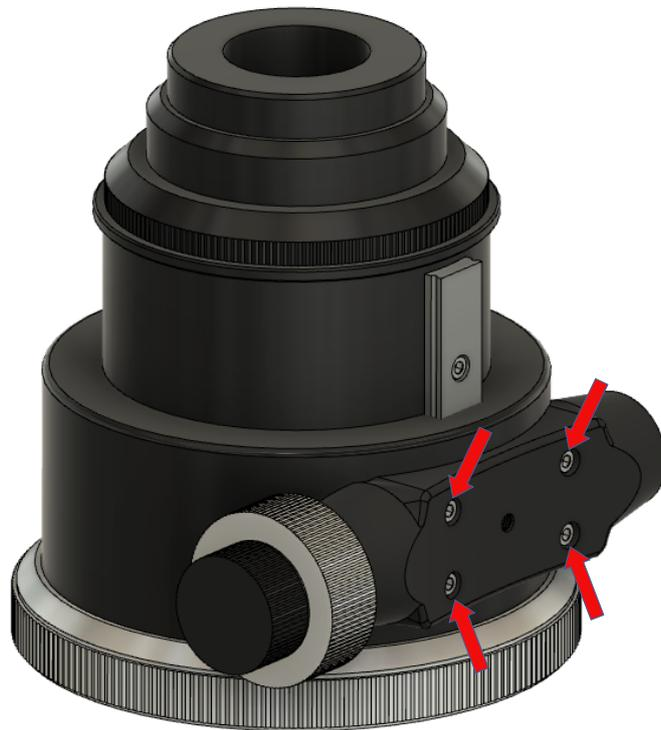
1. Die vier M3 Schrauben der Okularbefestigung heraus schrauben und die Halterung mit einer Hand weiter andrücken!
