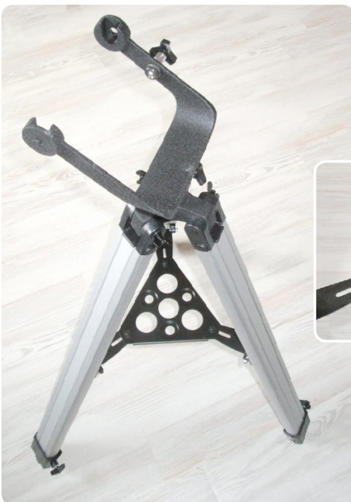
Befestigen Sie nun die Ablageplatte an den beiden anderen Halblechen.
