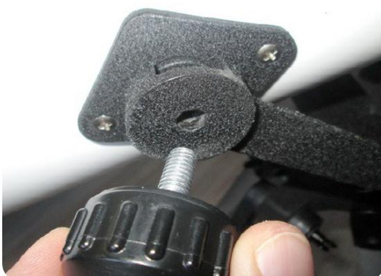
Befestigen Sie das Teleskop mit den beiden Schrauben ‚N‘ an der Montierung. Ziehen Sie die Schrauben nur „handfest“ an, damit sich das Teleskop noch in der Montierung bewegen lässt.
