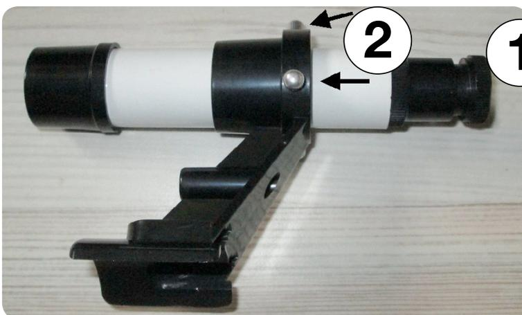
Schauen Sie jetzt von hinten in das Sucherteleskop (im nebenstehenden Bild auf der rechten Seite dargestellt). Verstellen Sie mittels der Verstellechrauben (2) den Sucher so lange, bis Sie das gleiche Objekt wie im Okular sehen. Scharfstellen erfolgt durch Drehen des Okulars.
