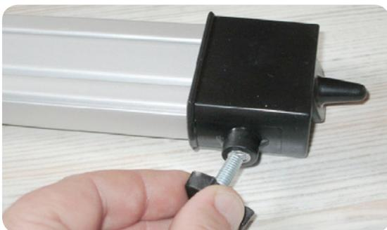
Schrauben Sie bitte zuerst die drei Schrauben ‚F‘ in die Gewinde der Stativbeine. Ziehen Sie aber die Schrauben nicht zu fest an, nur „handfest“. Sie können später mittels dieser drei Schrauben die „Arbeitshöhe“ des Stativs verändern oder auch das Stativ an einen unebenen Boden angleichen.
