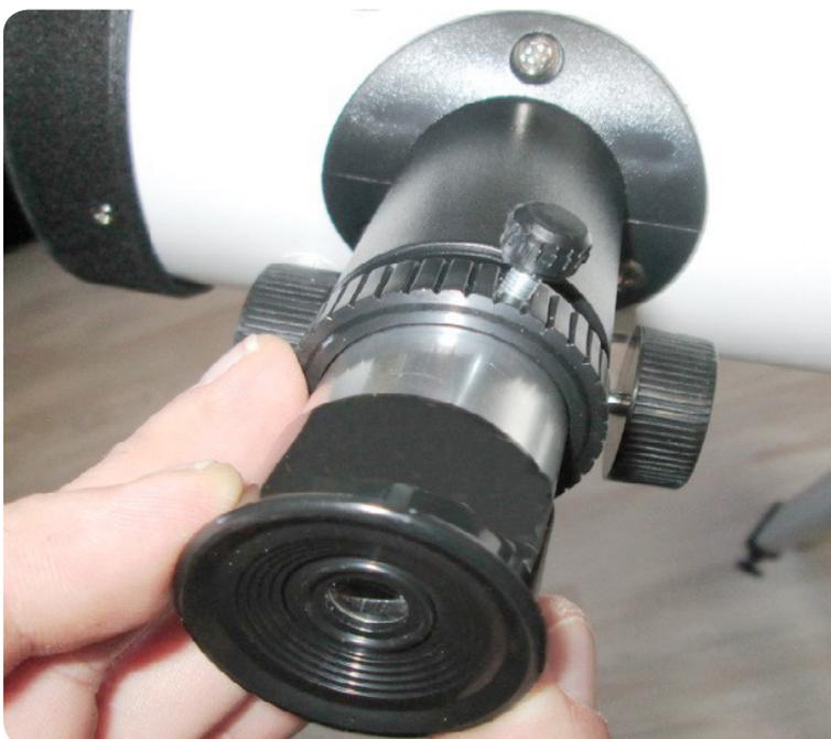
Nun müssen Sie noch den Sucher zum Teleskop ausrichten (justieren). Dazu stecken Sie zunächst das Okular mit der größten Brennweite in den Okularauszug und klemmen es mit der seitlichen Scharube fest.
