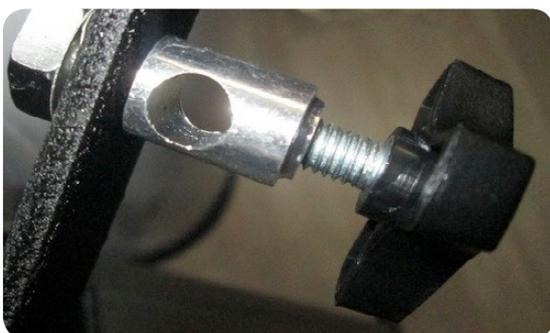
Schrauben Sie als nächstes die Halterung für den Feintrieb an der Montierung auf.
