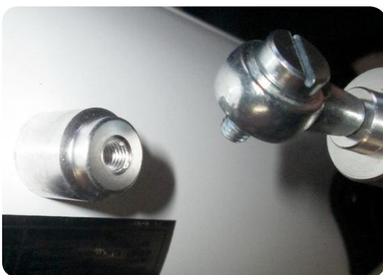
Stecken Sie die Feintrieb-Stange in die Halterung an der Montierung.
