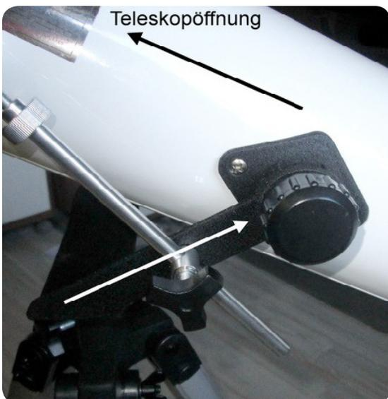
Wichtig beim Einsetzen des Teleskop ist, dass das vordere Ende des Teleskops (Öffnung) in die entgegengesetzte Richtung der Neigung der Montierungsgabel zeigt.
