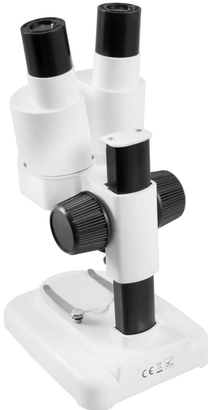
Die Fokussierung erfolgt über eine Zahnstange. Stellen Sie das Binokular so ein, das sich für beide Augen dasselbe Bild ergibt und stellen Sie mit der Fokussierung scharf.
