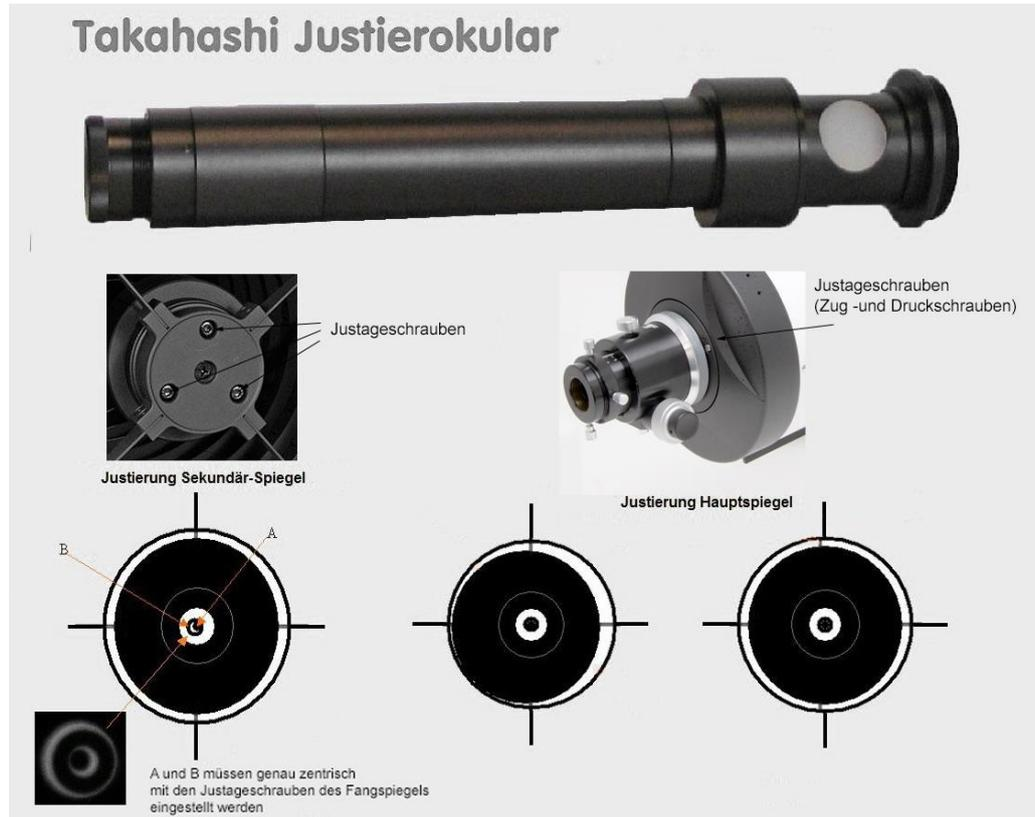
Die groben Einstellungen von Primär- und Sekundärspiegeln können in Innenräumen durchgeführt werden, während ein genauere Sterntest vor Ort durchgeführt werden muss.
