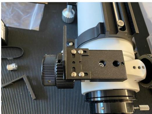
Nun wird das L-bracket, welches mittels 4x M3 6mm an dem Adapter befestigt ist, an das Gehäuse der Fokussiereinheit geschraubt. Dazu wird eine der beiliegenden kurzen Zylinderkopfschrauben benötigt.
