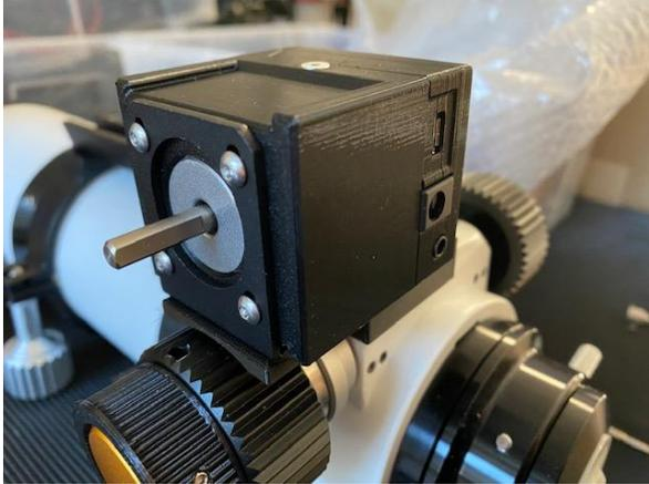
Als nächstes wird der AF3 mit den 4x Linsenkopfschrauben an dem L-bracket befestigt.
