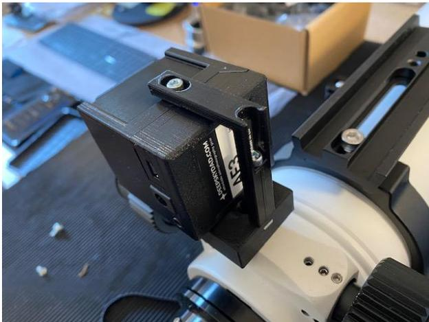
Befestigen Sie den Spannarm wie oben gezeigt an Adapter und AF3-Gehäuse.
