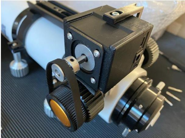
Ziehen Sie den Riemen über den Fokussierknopf-Adapter und das Riemenrad und schieben Sie gleichzeitig das Riemenrad auf die Welle des AF3.
